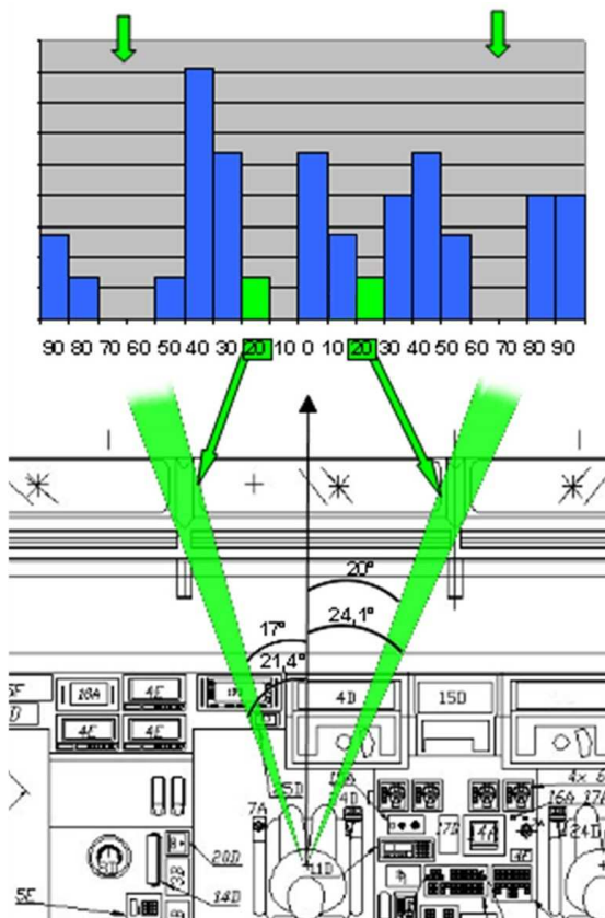
Figure 10 : Impacts des zones d'ombres de la passerelle (fond © Alstom) sur les gisements des détections de grands cétacés effectuées par les officiers (gisements en abscisses et pourcentages de détections en ordonnées).
